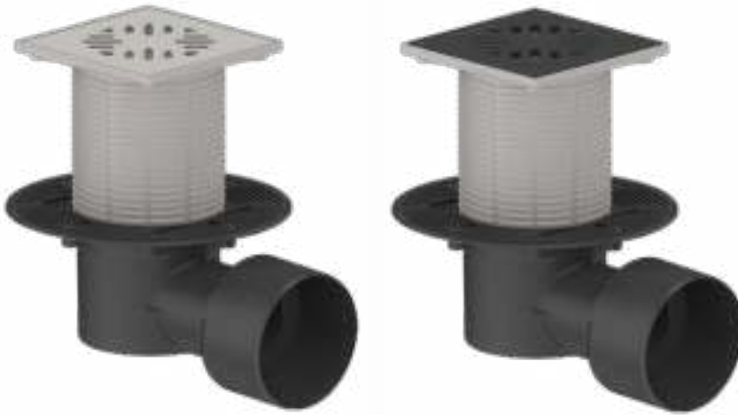
ТП-5100 Трап регулируемый с горизонтальным выпуском 75/110 мм
